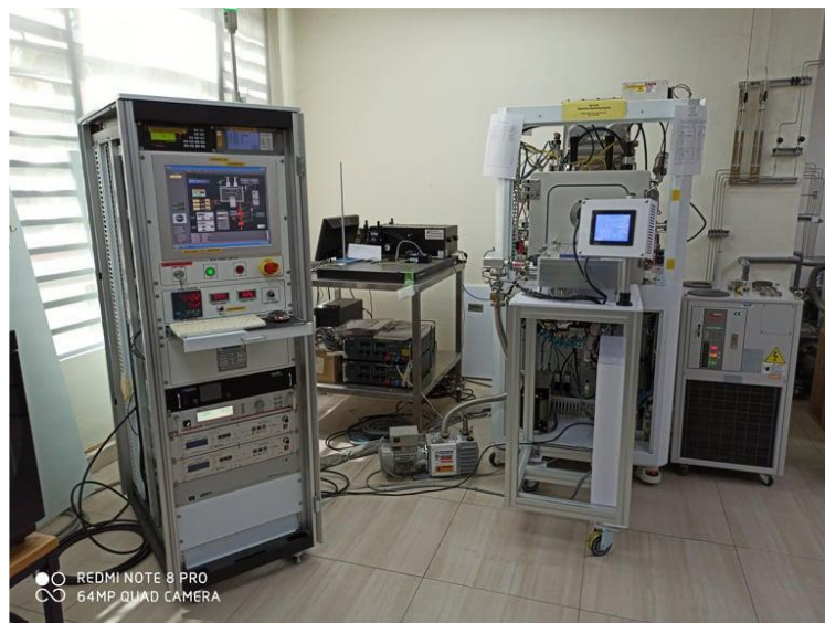
Figure II-3 : Système de dépôts industriel SNTTEK/korea (Centre MiNT-SRC Malaisie)
