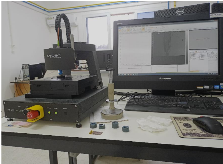
Figure II-17 : Le profilomètre optique CYBER TECHNOLOGIE CT100 (ENSTI).
