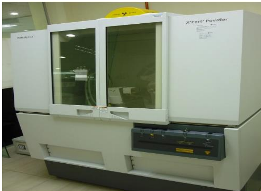
Figure II-11 Diffractomètre à rayons X (DRX) PanAnalytical (Laboratoire PIC : Responsable de MiNT-SR (Malaisie)).
