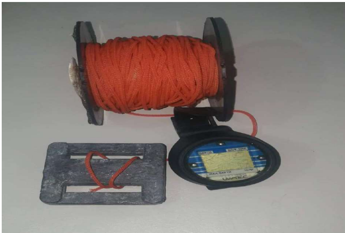
Figure 22: Photographie montrant le dispositif de mesure de la profondeur sur le terrain: profondimètre électronique et corde graduée équipée d'un plomb pour les relevés bathymétriques.
