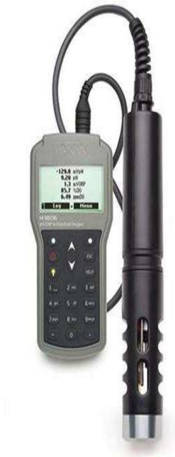
Figure 18: Photographie montrant le multiparamètre étanche pour mesurer utilisé pour mesurer le pH, l'O 2 , la DO, la pression et la température dans l'eau (Hanna instruments - hi98196).
