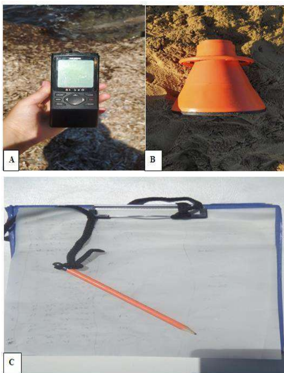
Figure 21: Equipements utilisés pour le relevé des points vérité: (A) GPS Garmin portable pour la géolocalisation, (B) lunettes de calfat pour l'observation des fonds, (C) papier calque pour le report cartographique initial.
