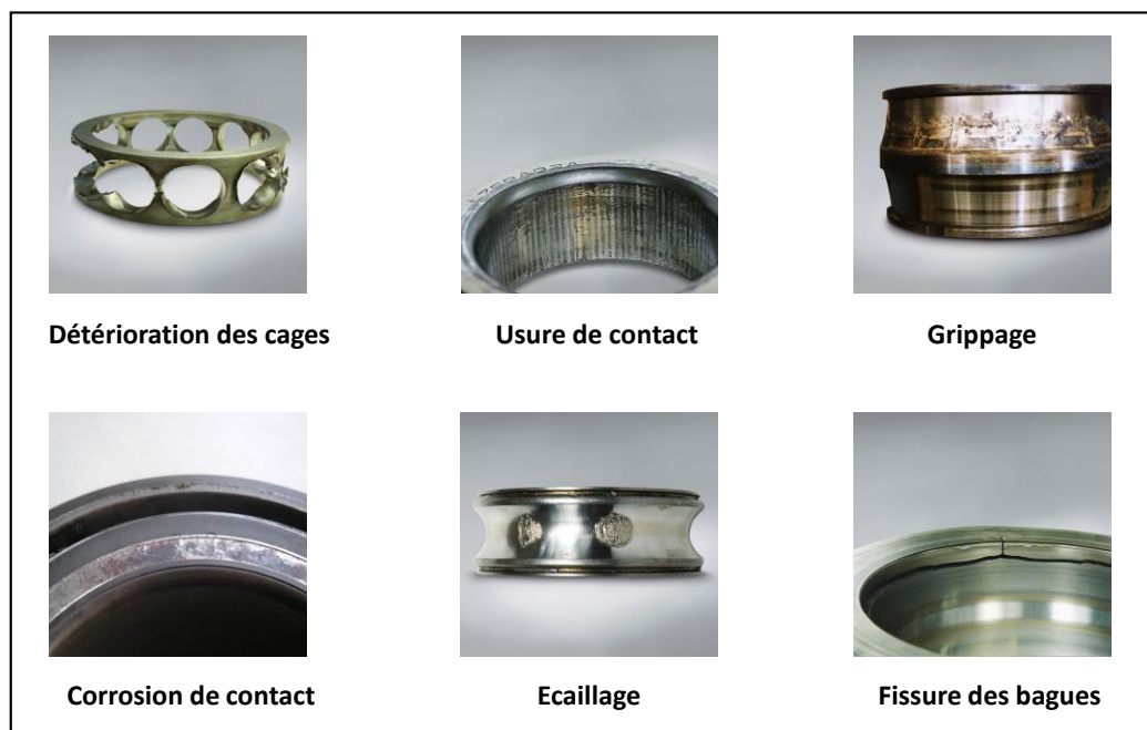
Figure I. 4 Exemples des avaries affectant les roulements.
