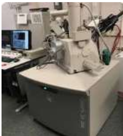
Figure III.11 Microscopie électronique à balayage (MEB) FEI de type QUANTA 250.
