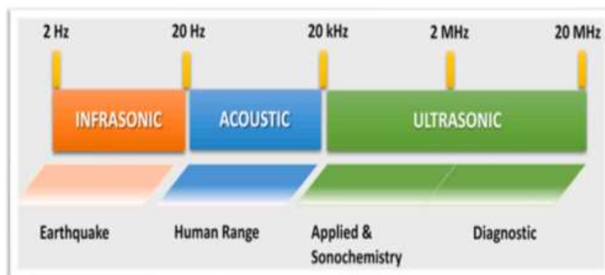
Figure I.2 Différentes gammes de fréquences des ondes ultrasonores.
