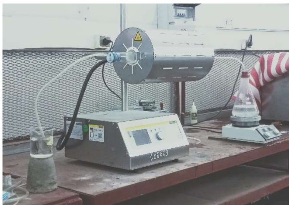
Figure III.2 Installation de la calcination du CA sous vapeur d'eau.
