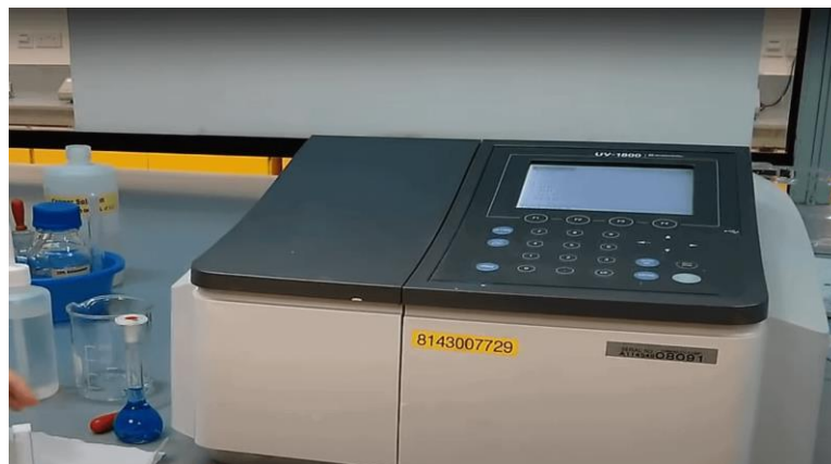
Figure II.10 : Spectrophotomètre UV-VIS utilisé pour analyser les films préparés.
