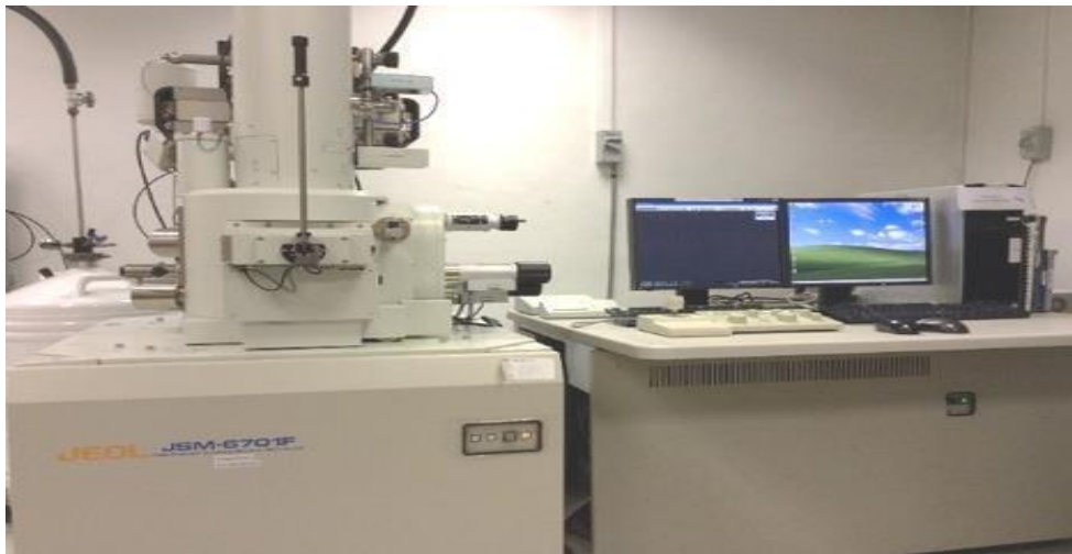
Figure II.13: Image d'un microscope électronique à balayage (FESEM, JEOL, JSM-6701F).
