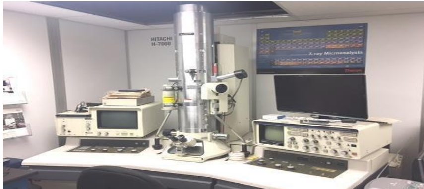
Figure II.15: Microscope électronique à transmission du type Hitachi H-7000.
