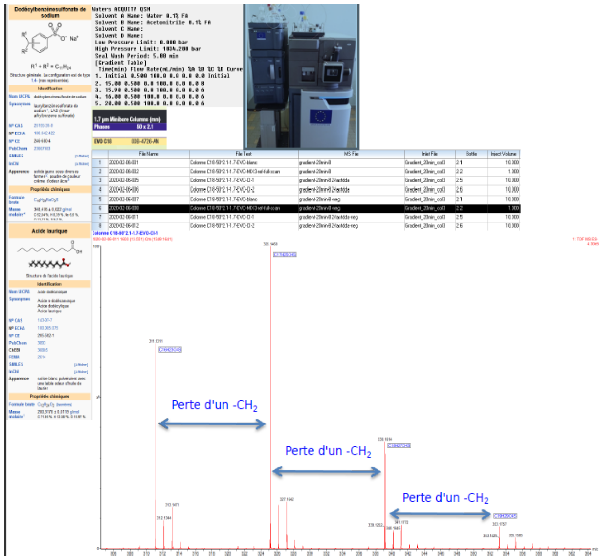
Figure IV.7. Analyse de la composition de la solution de SDBS par LC-MS.
