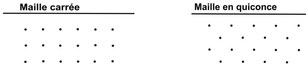
Figure 1.9. Principaux types de maille utilisés pour les tirs en ciel ouvert
