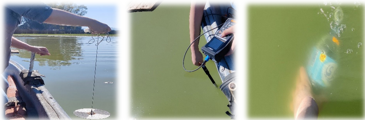
Figure 6 : collecte de l'eau, mesures des paramètres physicochimiques et transparence in situ
