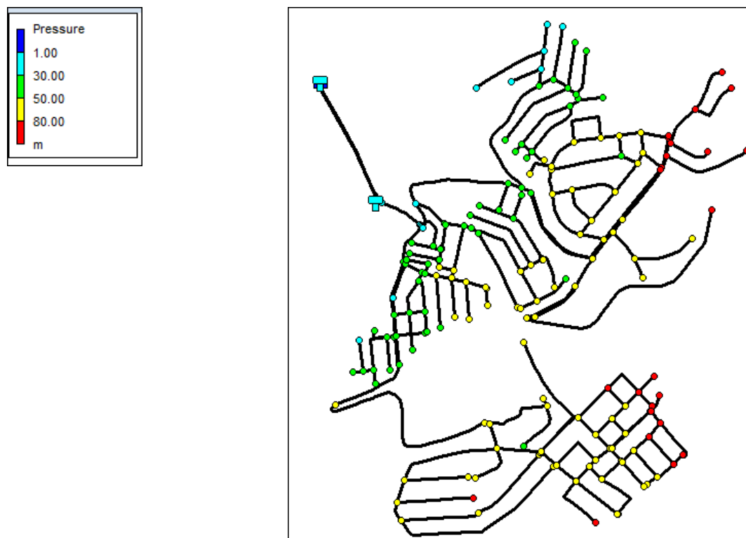
Figure 4.19. La simulation hydraulique du réseau étudié (Epanet2®)
