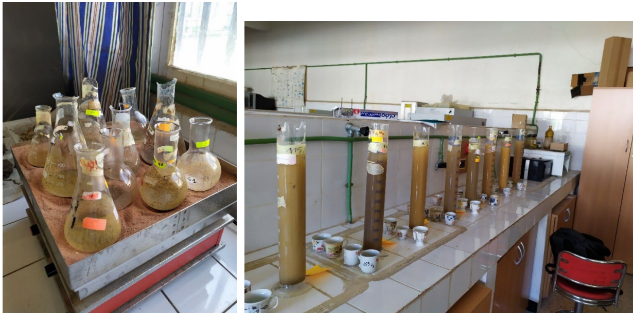
Figure 32. Photos montrant les étapes du protocole de la granulométrie.
