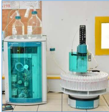
Figure 8. Chromatographe Ionique avec Analyse Automatisée des Paramètres Physico-Chimiques - Système Metrohm (Photo personnelle, 2025).
