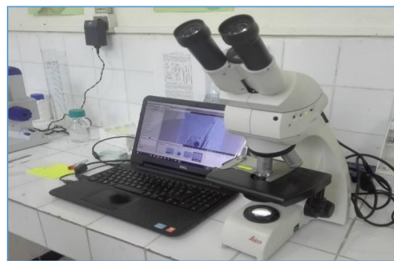
Figure 20. Microscope optique « Leica DM500 » connecté à un ordinateur équipé d'un logiciel dédié aux mesures du diamètre des ovocytes (Photo personnelle, 2025).
