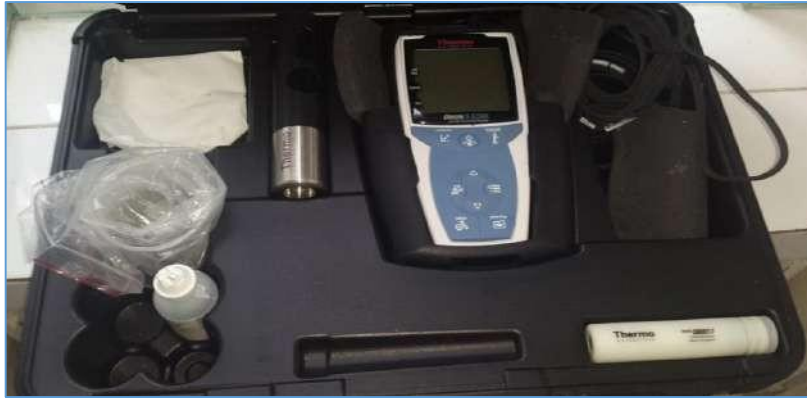
Figure 7. Multi-paramètre pour la mesure des paramètres physico-chimique généraux « Thermo scientific Orion 5-star » (Photo personnelle, 2025).
