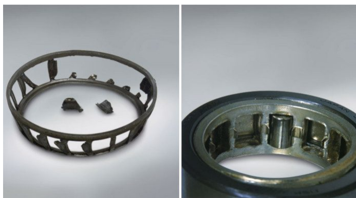
FIGURE II.2 – Défaut de cage [39].
