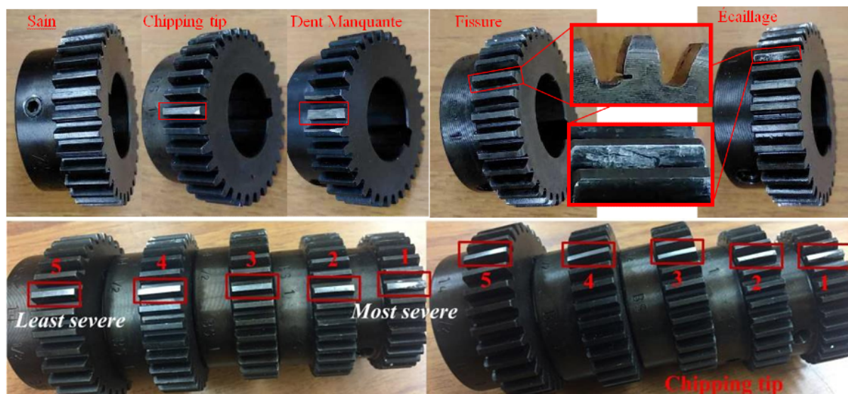
FIGURE IV.3 – Neuf pignons avec différents états de défaut (cinq niveaux de gravité pour la pointe éclatée).
