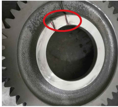
FIGURE II.4 – Défaut de l'arbre d'engrenage [41].
