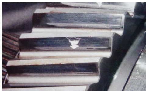
FIGURE II.6 – Défaut d'engrenage par fatigue de contact [43].
