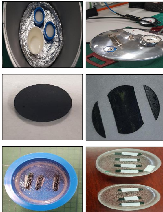
Figure III 12. Préparation avant le polissage : découpage, enrobage à chaud des échantillons.
