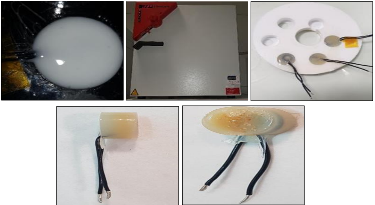
Figure III 19. Procédure d'encapsulation des échantillons dans une résine époxy.
