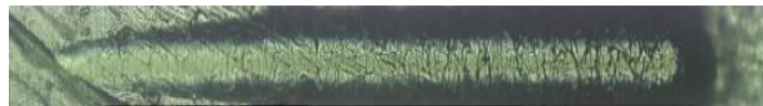
Figure III.24. Micrographie optique de la rayure lors de l'essai de rayure (scratch test) du dépôt de chrome sur la surface polie
