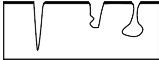
Figure I.4. Aspect morphologique des différentes formes de corrosion localisée se produisant sur les métaux [25], [26]
