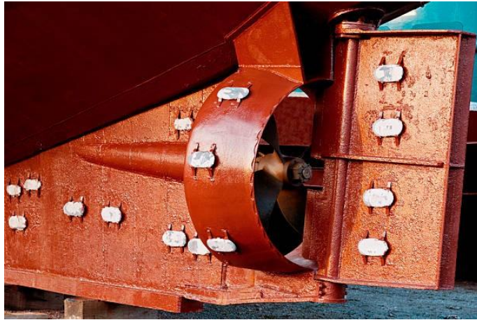
Figure I.5. Protection cathodique des navires par anode sacrificiel de zinc
