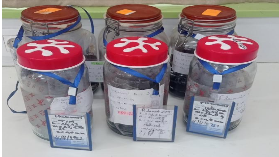
Figure II. 9. Parallélépipèdes immergés dans les solvants.
