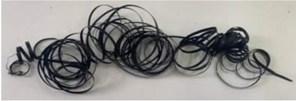
Figure III. 7. Un filament complet issu d'un rainurage représentatif de toute l'épaisseur du tube (~12 m de long).
