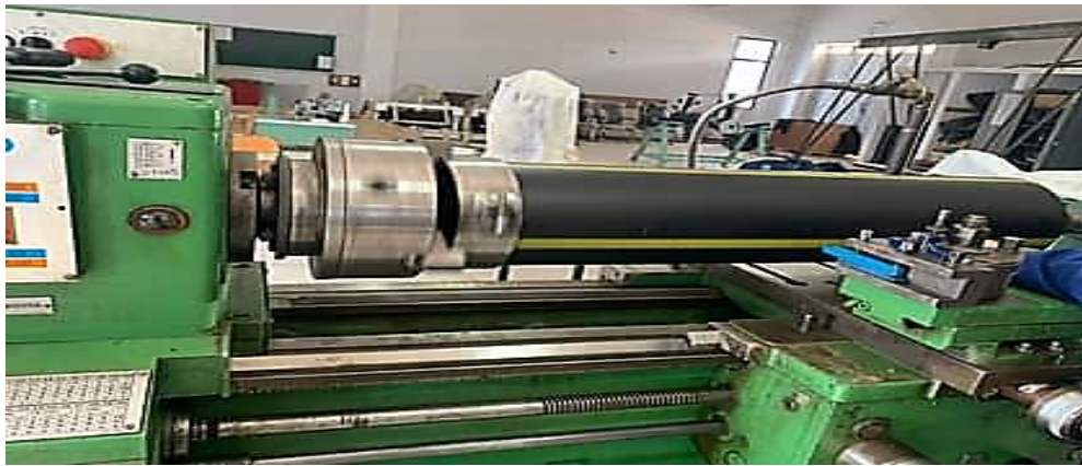
Figure II. 1. Pipe HDPE sur tour universel.
