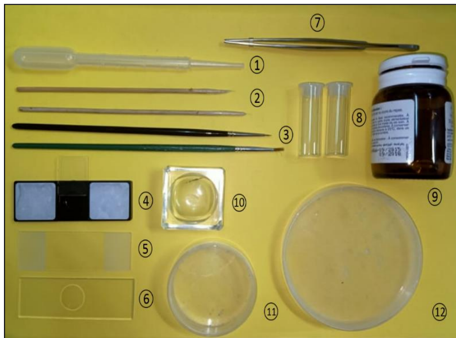
Figure 32. Outils de dissection : 1. Pipette, 2. Aiguilles de dissections, 3. Pinceaux fins, 4. Lame microscopealéontologique, 5. Lames et lamelles, 6. Lame à concavité, 7. Pince flexible, 8. Fioles en verre, 9. Flacon d'Hydro-Matrix, 10. Récipient en verre, 11. Boite de Pétri de petite taille, 12. Boite de Pétri de grande taille.
