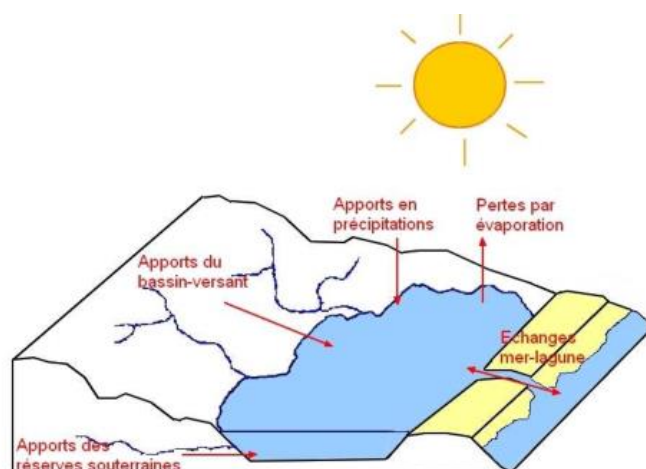
Figure 1. Schéma simplifié du fonctionnement hydrologique d'une lagune méditerranéenne (Trinquier, 2009)
