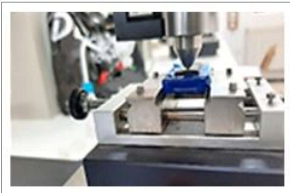
Figure II. 19 : Équipement du scratch test des laboratoires de l'ENSTI / Annaba
