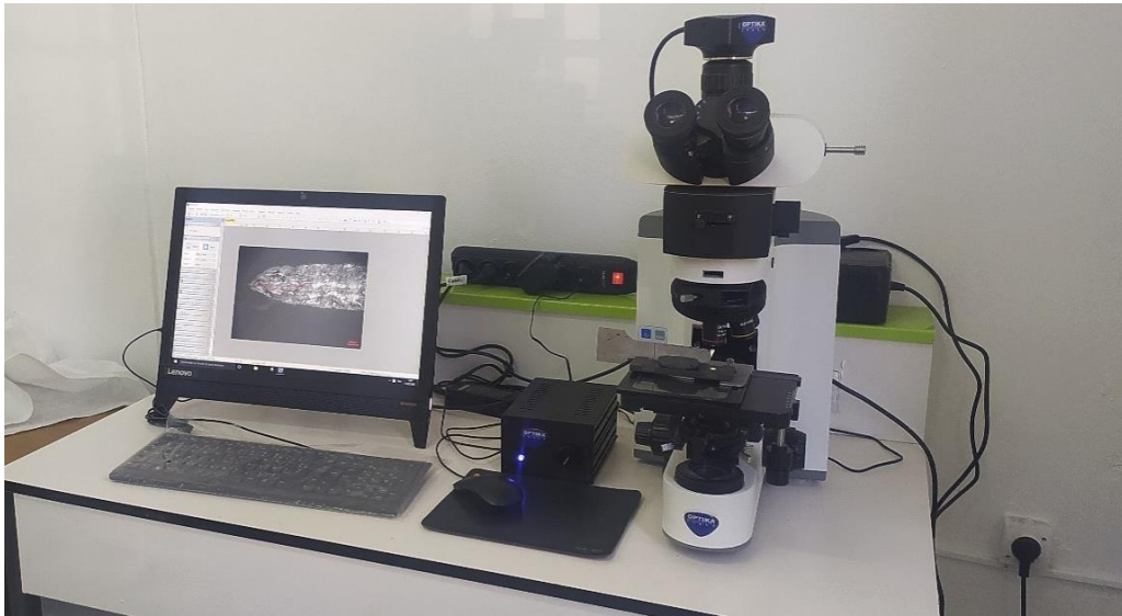
Fig.30 : mesure de l'épaisseur à l'aide du microscope optique.
