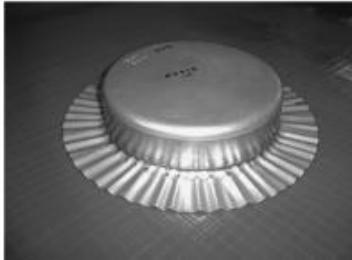
Fig.4 : Plissement dans la collerette (sous serre-flan) [2]
