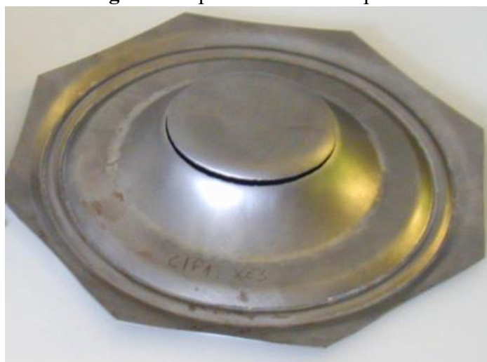
Fig.63 : rupture de l'échantillon (essais de Marciniuk) [29]
