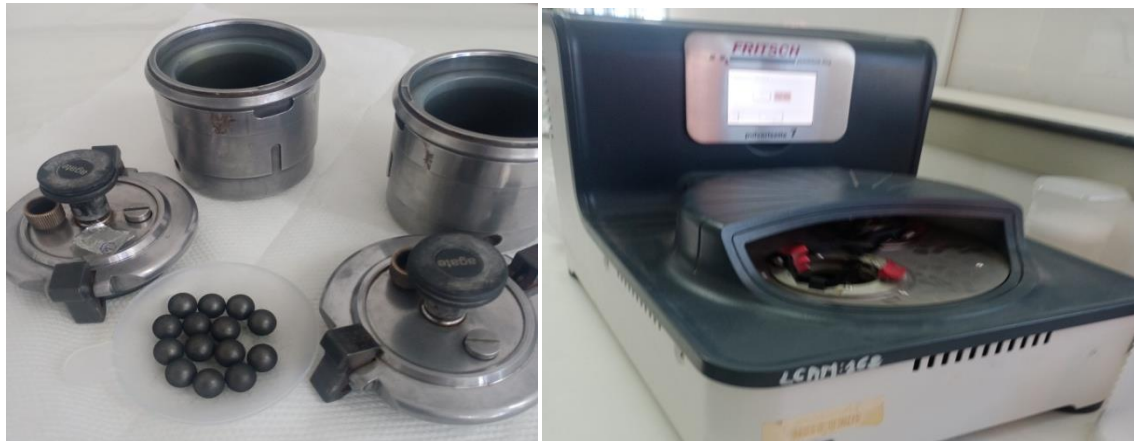
Figure II-1 : Diagramme schématique du mouvement planétaire et du broyeur à boulets.
