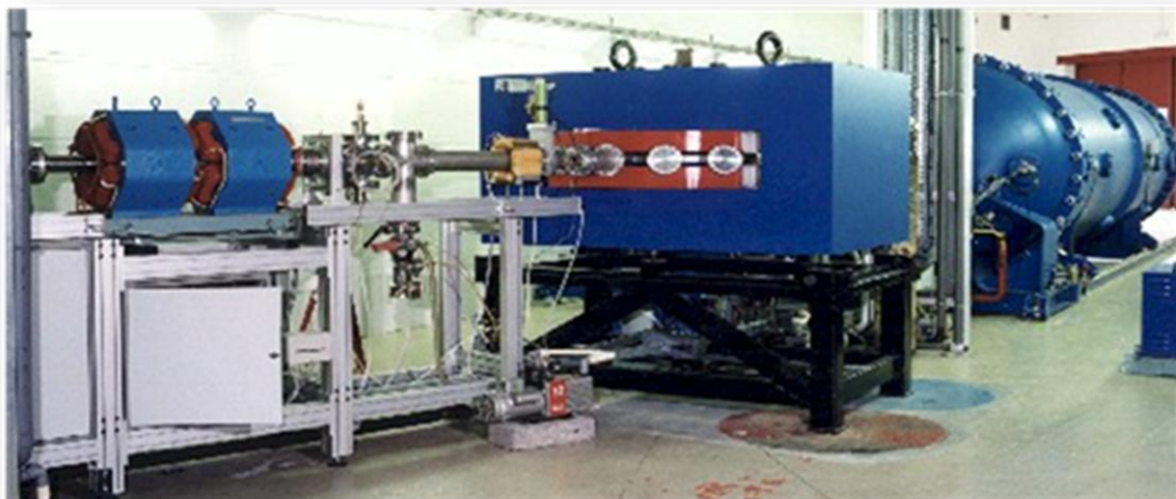
Figure II-11: Accélérateur Van de Graaff KN 4000 horizontal
