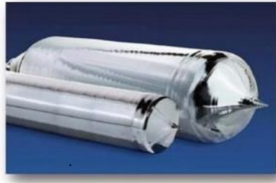
Figure I.20 : Lingots de silicium cristallin élaborés par la technique Czochralski [17].
