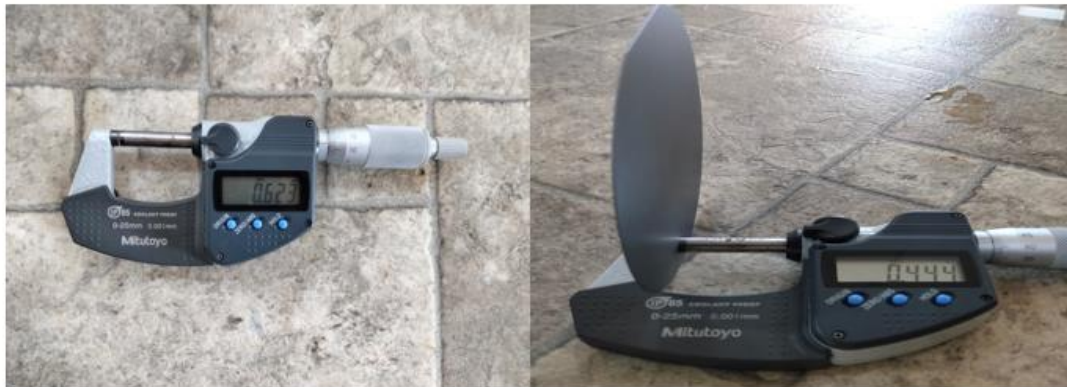
Figure III.4 : Photographies d'une mesure de l'épaisseur d'une plaquette de silicium Si-Cz en utilisant un palmer digital.
