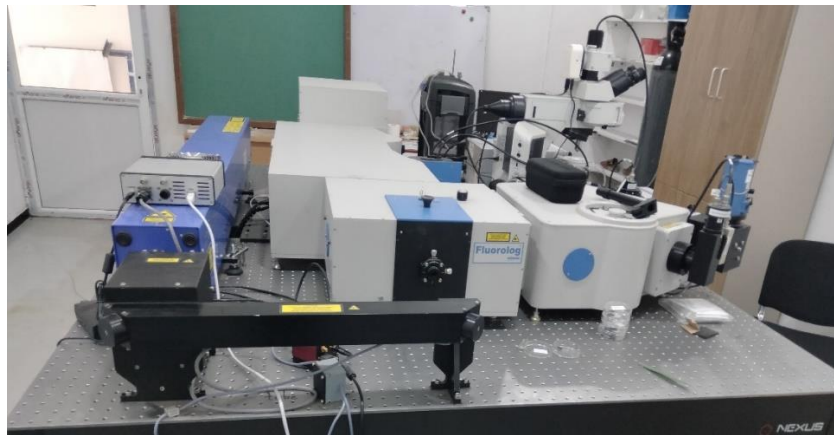
Figure III.19 : Photographie du banc de Photoluminescence FL3-DFX-iHR320 .
