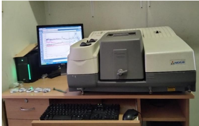
Figure III.18 : Photographie de l'équipement FTIR : l'instrument FTIR Thermo Nicolet NEXUS 670 .
