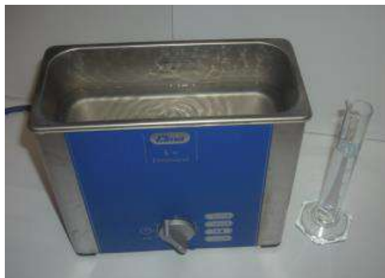
Figure I.10 : Bac à ultrasons basse fréquence (50 kHz) largement répandu dans les laboratoires.
