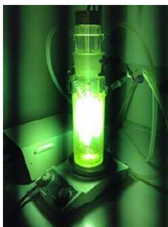
Figure I.3 : Réacteur photochimique à puits d'immersion (750 ml) avec lampe à vapeur de mercure.
