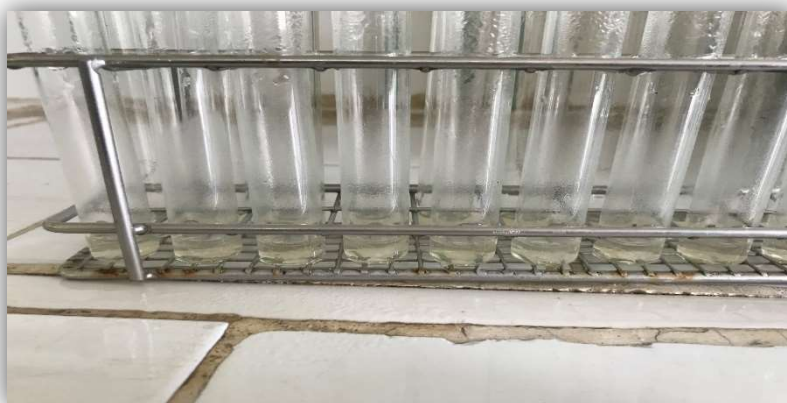
Figure 21 : présente une photographie illustrant des tubes à essai renfermant le résultat visuel de la condensation entre l'MDA et le TBA. ( Photo personnelle. )
