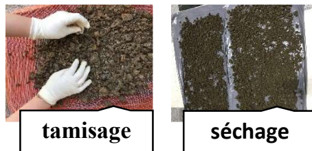
Figure 10: préparation du sol pour l'étude PH-CH.
