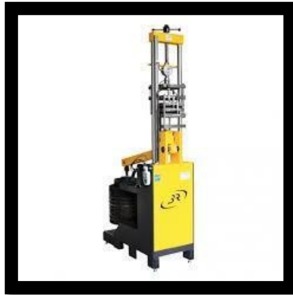
Figure II.5 Schéma d'une machine de fluage [77]
