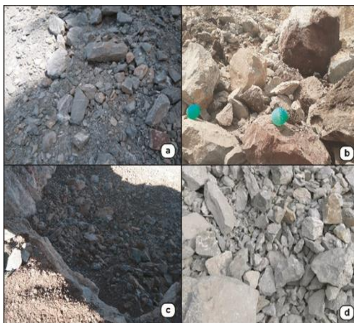
Fig. IV.11. Roches fragmentées après chaque opération de tir (a – première opération ; b – deuxième opération ; c – troisième opération ; d – plan de tir proposé).
