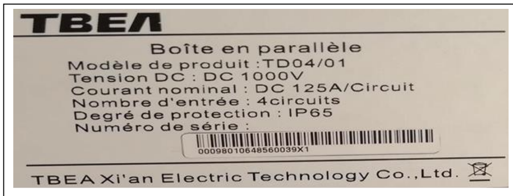
Figure 4.7. Plaque signalétique de la boîte parallèle niveau 1
