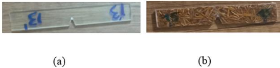
Figure 3.9 : Éprouvettes utilisées aux essais de choc Charpy. a) RE, b) LPE.
