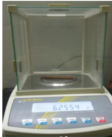
Figure 3.13 : Éprouvettes pesées par une balance KERN ALS 120-4N
