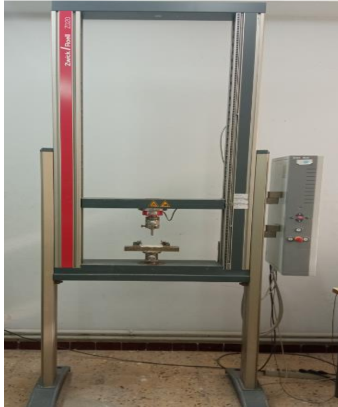
Figure 3.4 : Machine de flexion 3 points (Zwick Z020).
