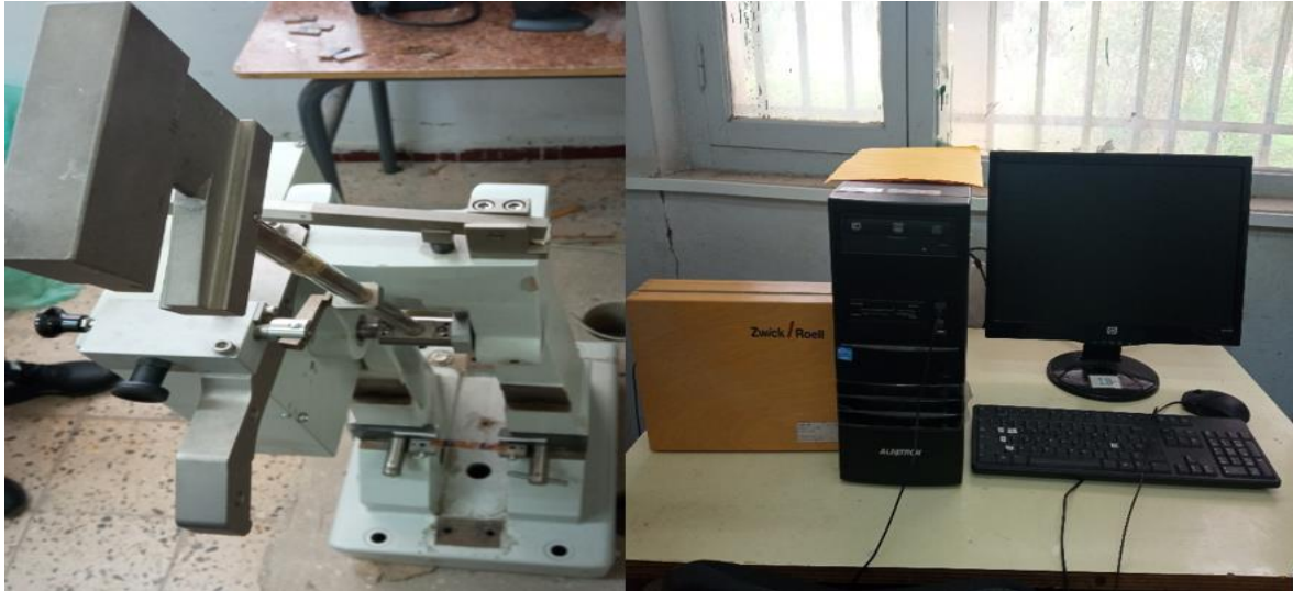
Figure 3.11 : Machine d'essai Charpy avec affichage numérique.
