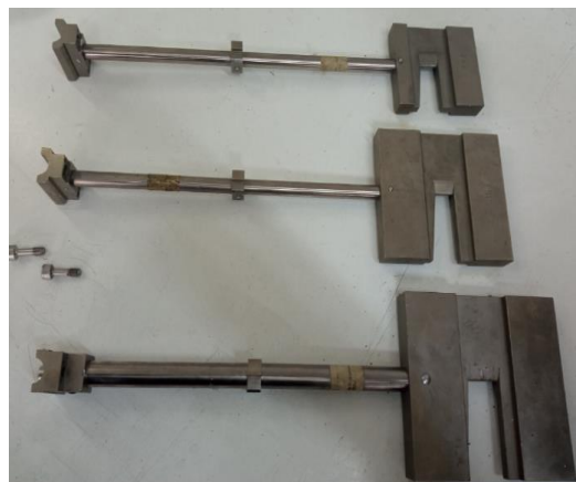
Figure 3.10 : Les pendules utilisés pour l'essai de choc
