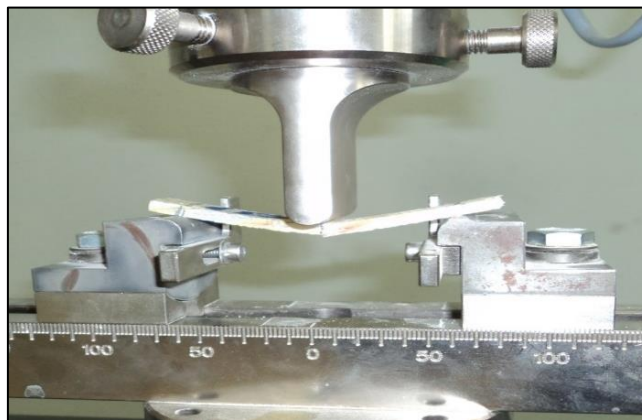
Figure 3.7 : Equipement de l'essai de flexion trois-points.
