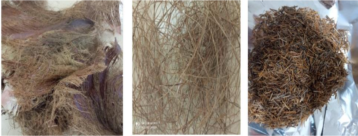
Figure 3.1 : Fibres de lif de palmier
