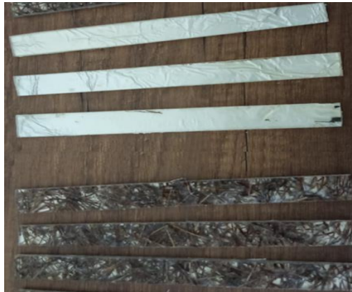
Figure 3.6 : Éprouvettes normalisées pour l'essai de traction.
