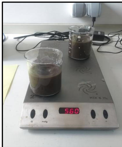
Figure 5.8. Lavage par attrition dans un agitateur magnétique.
