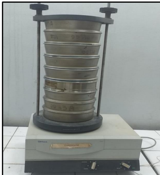
Figure 4.4. Tamiseuse électro-vibrante, LAVAMINE-UBMA.
