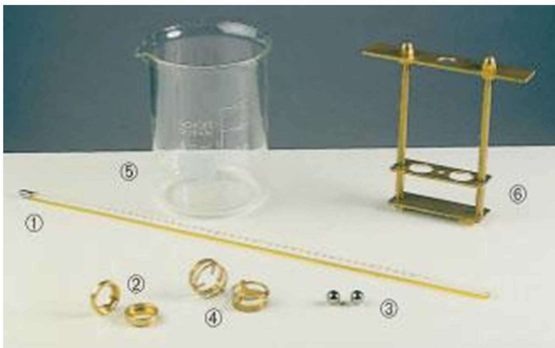
(1) Thermomètre ; (2) Anneau ; (3) Billes ; (4) Dispositif de centrage des billes ; (5) Bécher ; (6) Dispositif d'essai bille-anneau
