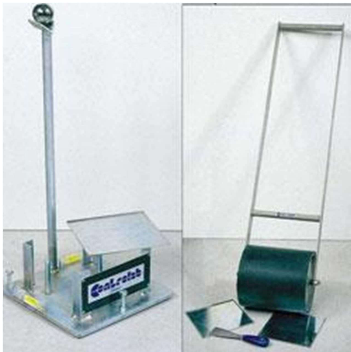
Figure III.1: Appareillage pour essai Vialit
