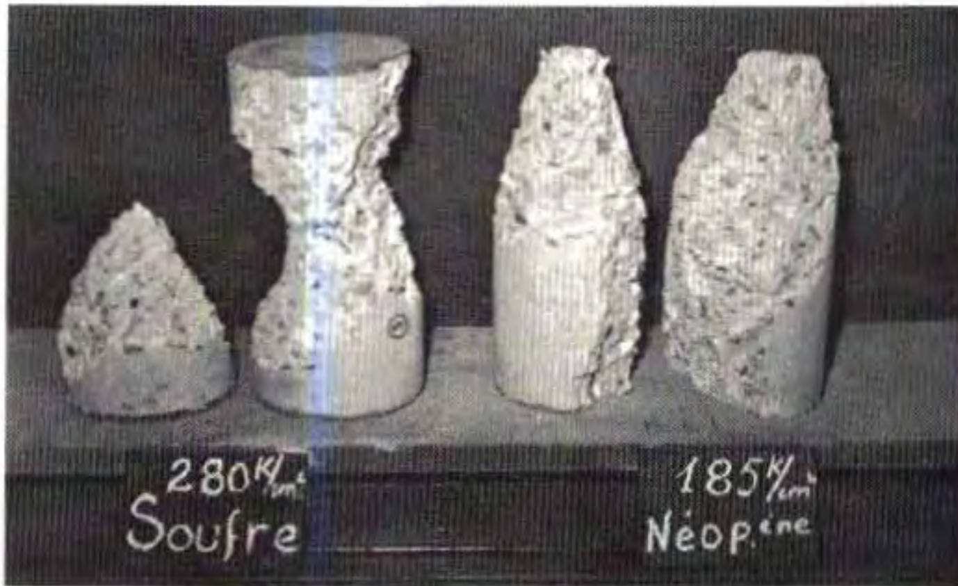
FIG. 56. — Formes de rupture obtenues avec du soufre dans un cas et des plaques de néoprène dans l'autre. Les résistances sont différentes.
