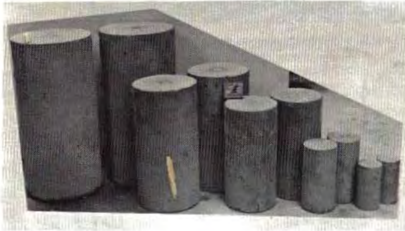
FIG. 37. — Les différentes éprouvettes cylindriques confectionnées pour les essais (11 à 40 cm de diamètre).
