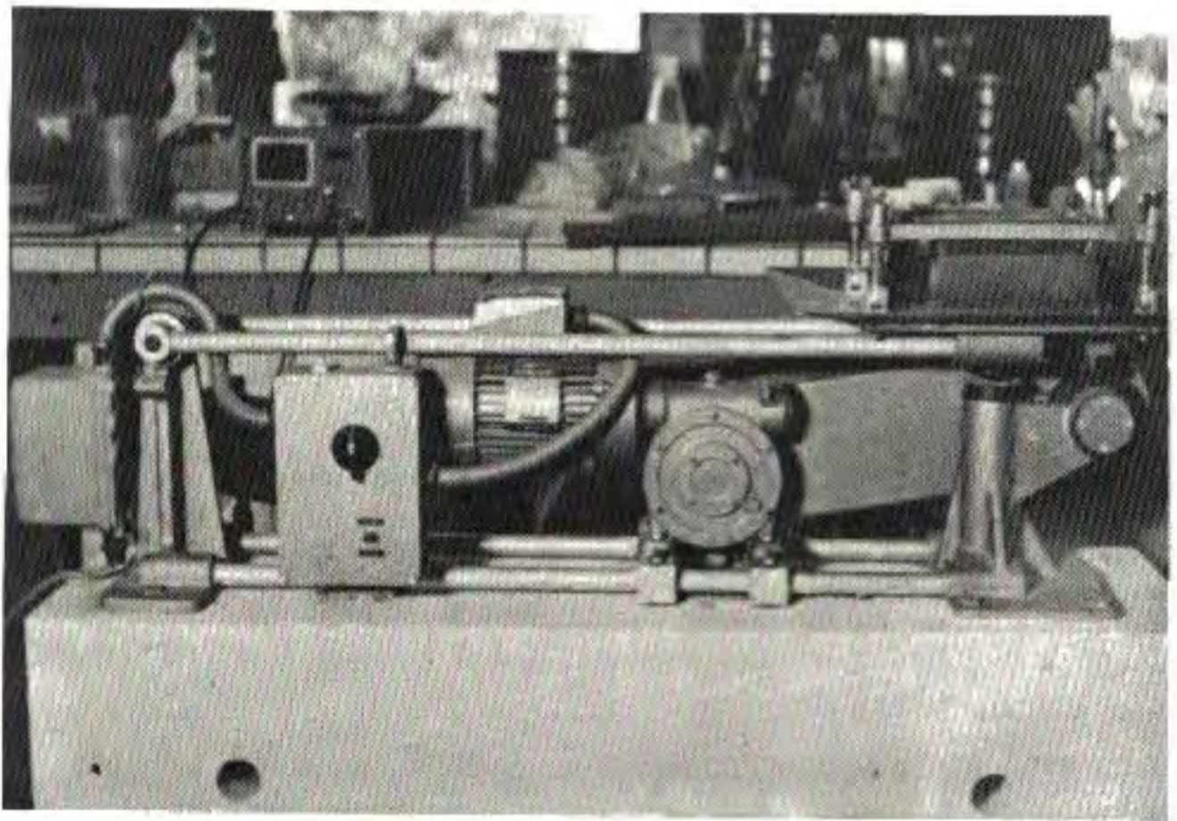
FIG. 8. — Machine à chocs pour mise en œuvre des éprouvettes 4 \times 4 \times 16 .
