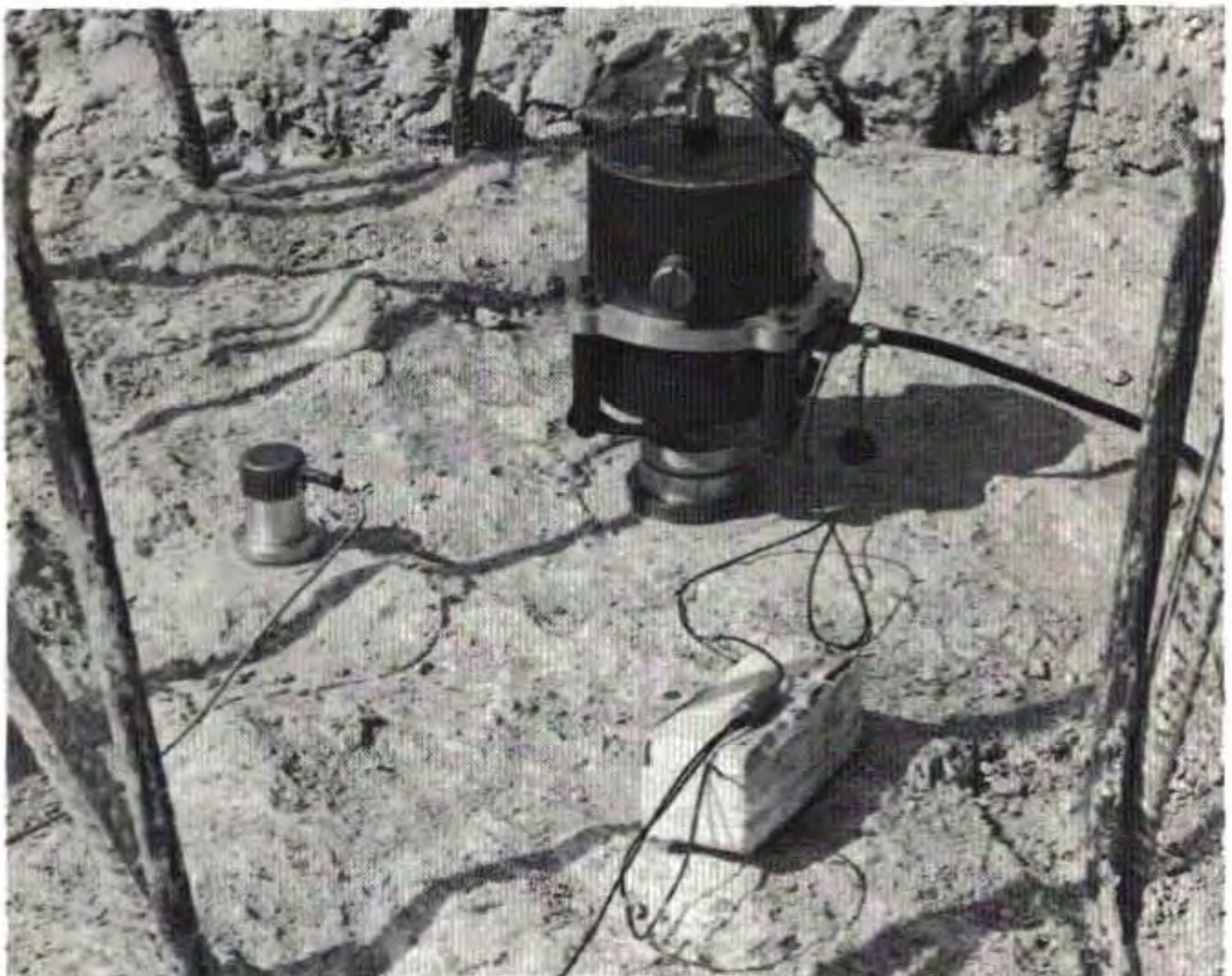
FIG. 92. — Mesure par impédance mécanique : l'excitateur électro-dynamique est placé au centre ; le capteur est excentré.
