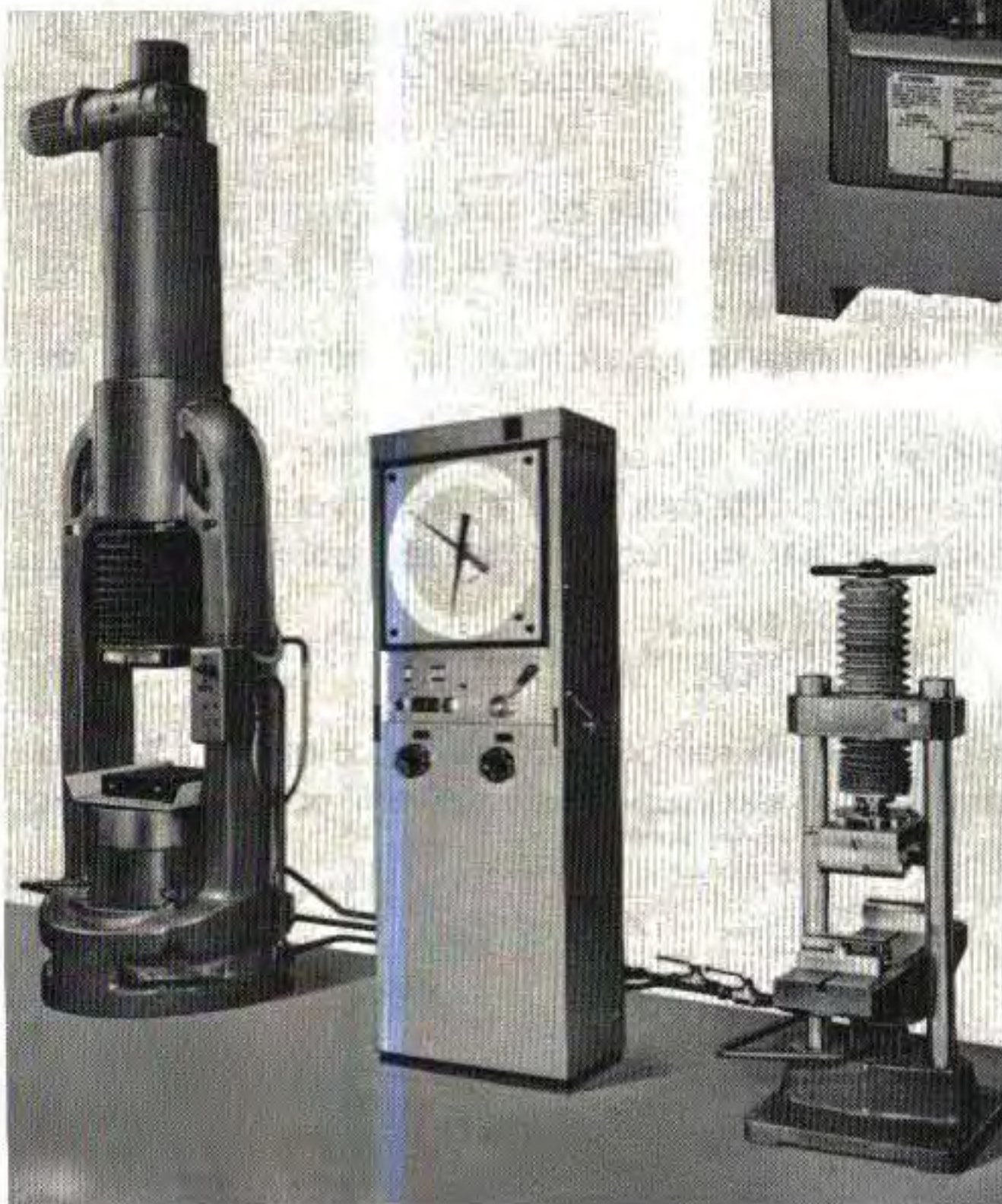
FIG. 52. — Machines de compression de 5 000 KN ( \sim 500 T) et de flexion 300 KN ( \sim 30 T) alimentées et commandées par un même groupe dynamométrique (Doc. PERRIER).
