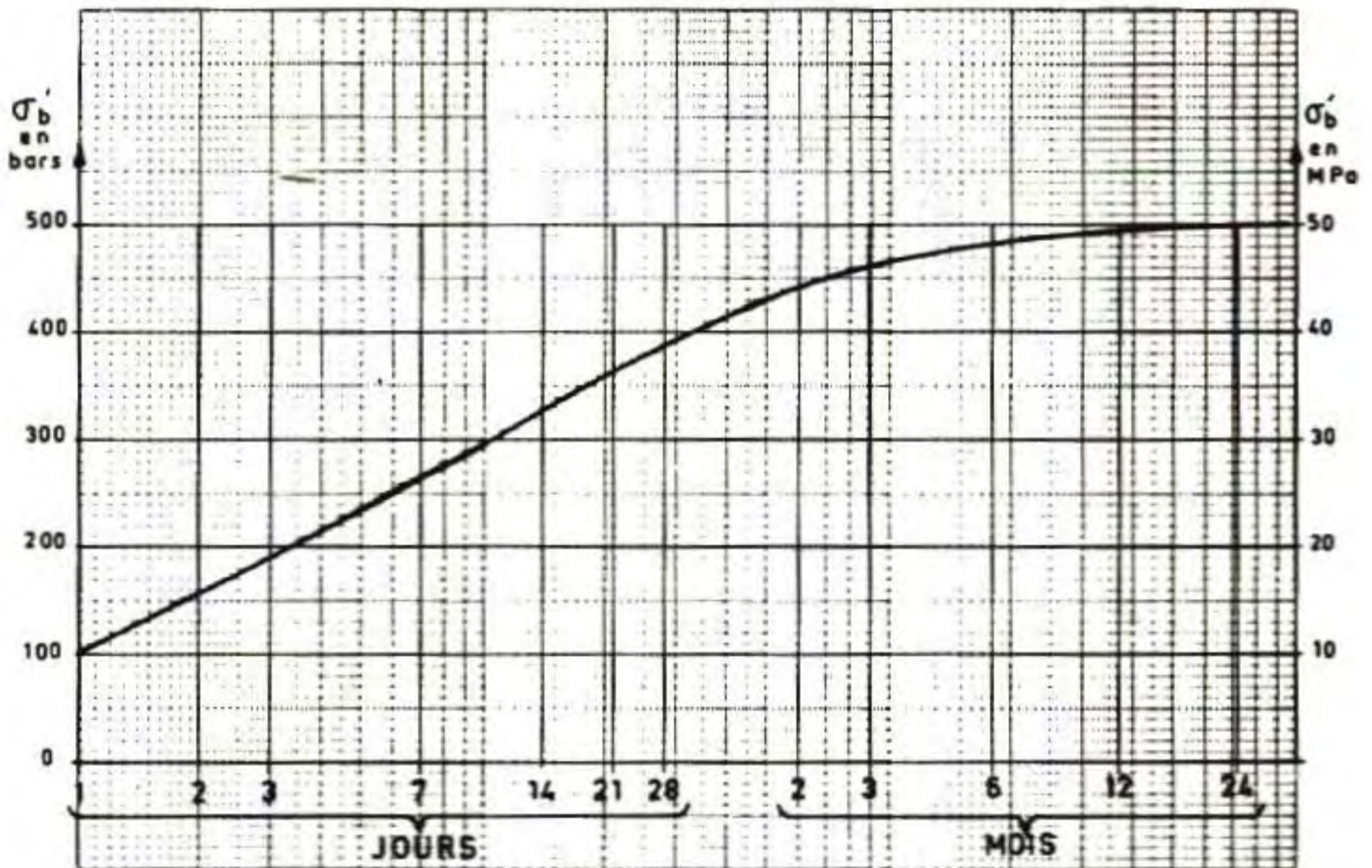
FIG. 34. — Évolution de la résistance jusqu'à deux ans d'un béton de qualité dosé à 350 kg de ciment par mètre cube.
