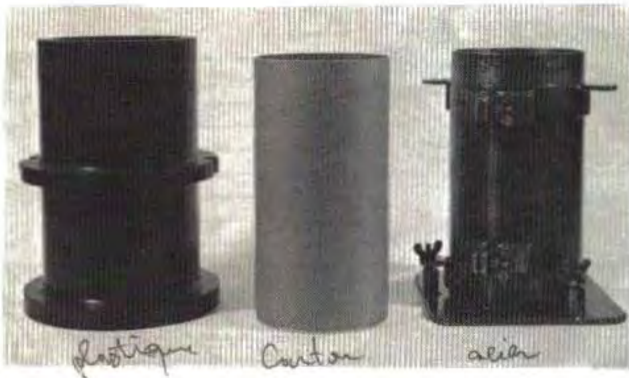
FIG. 41. — Nature des moules utilisés actuellement. De gauche à droite : matière plastique, carton, acier.
