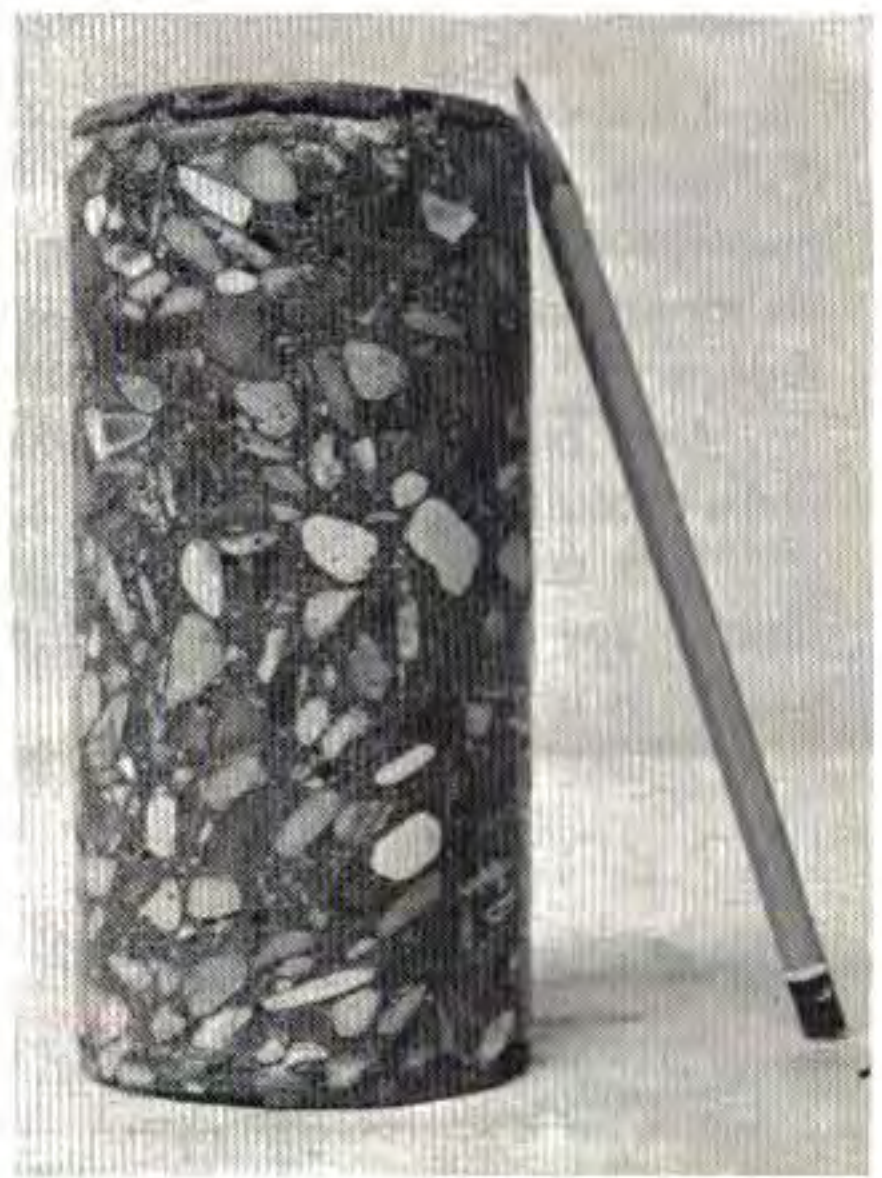
FIG. 81 bis. — Carotte 10 × 20 cm extraite d'un bon béton.
