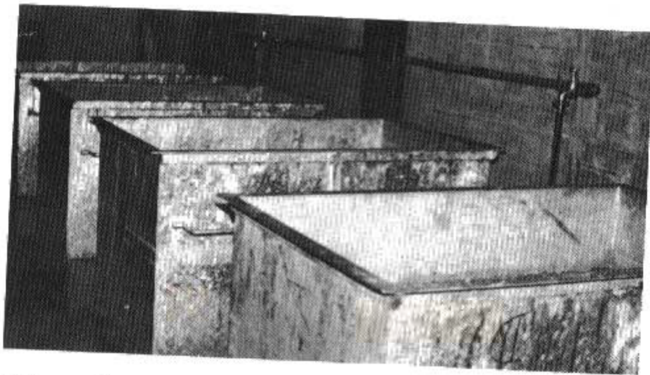
FIG. 3. — Bacs de conservation en tôle galvanisée pour éprouvettes.
