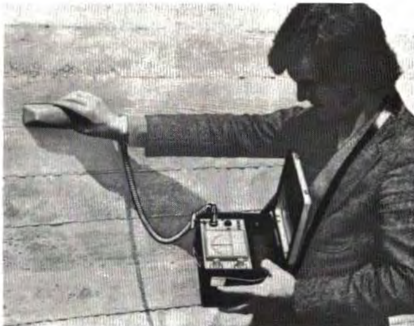
FIG. 93. — Repérage des armatures à l'aide du profomètre (doc. PERRIER).
