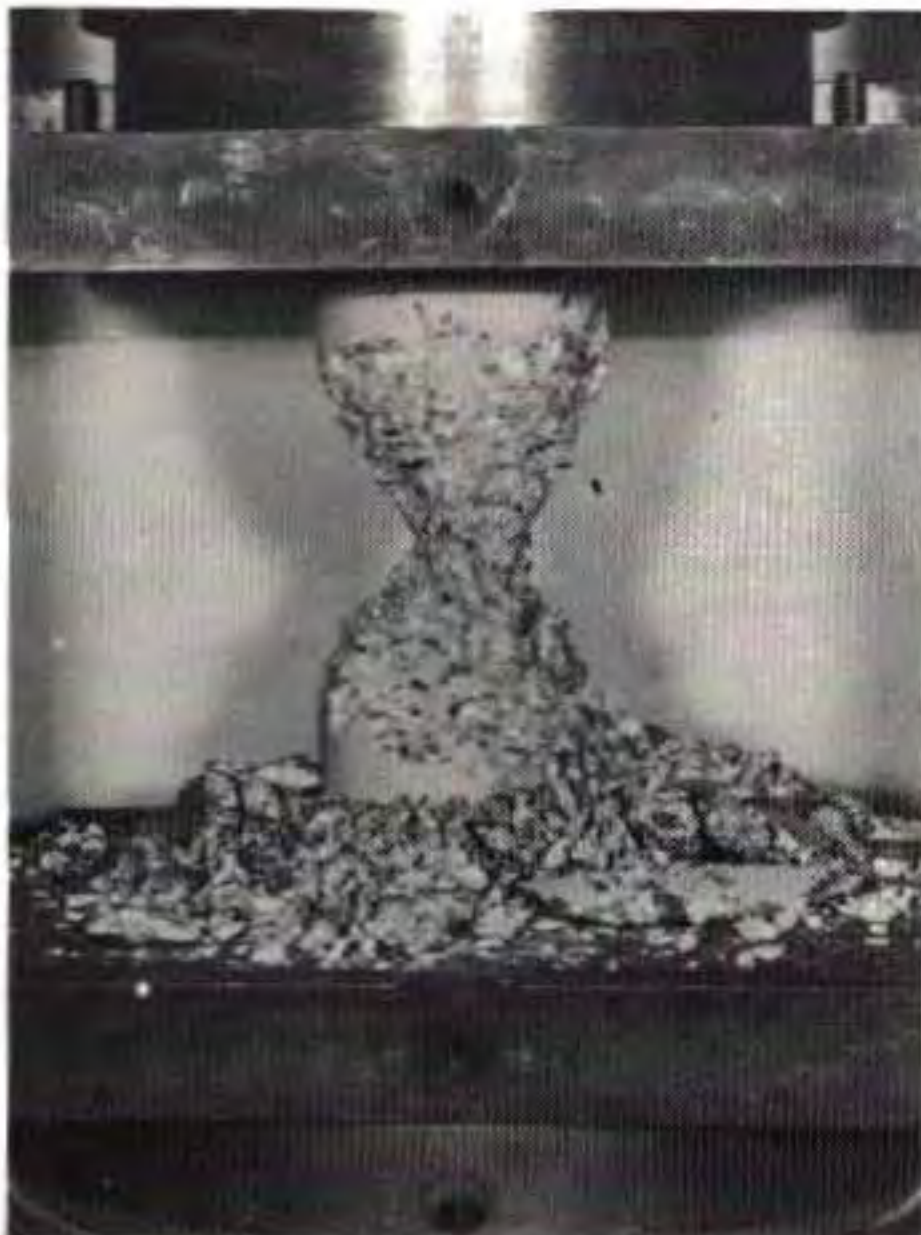
FIG. 55. — Forme de rupture normalement constatée avec le surfaçage au soufre.
