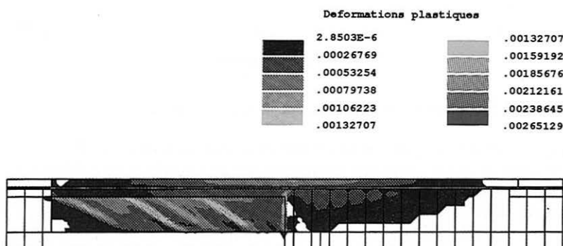
a) - Ensemble de la poutre ( F = 408 kN).
